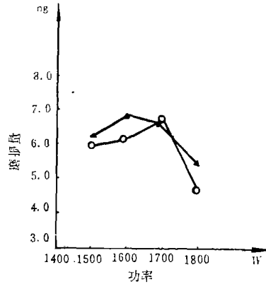
图 1 激光束功率对磨损量的影响, 扫描速度 20mm/s, 离焦量 55mm
